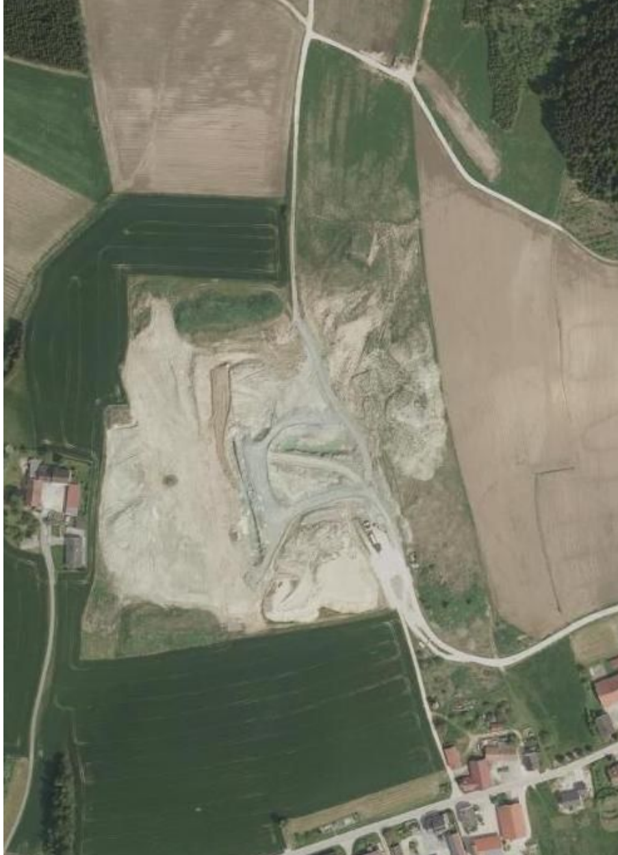
Die für die Photovoltaik-Freiflächenanlage beantragte Fläche wurde als Tontagebau der Firma Clariant zum Abbau von Bentonit genutzt. Die Planfläche liegt in dem bereits wiederverfüllten und landwirtschaftlich genutzten Bereich unmittelbar östlich des abgebildeten Abbaubereichs.
