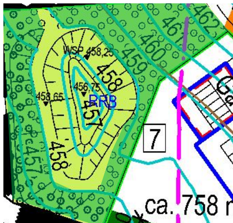
Ersatz-Gehölzpflanzung am Rückhaltebecken
