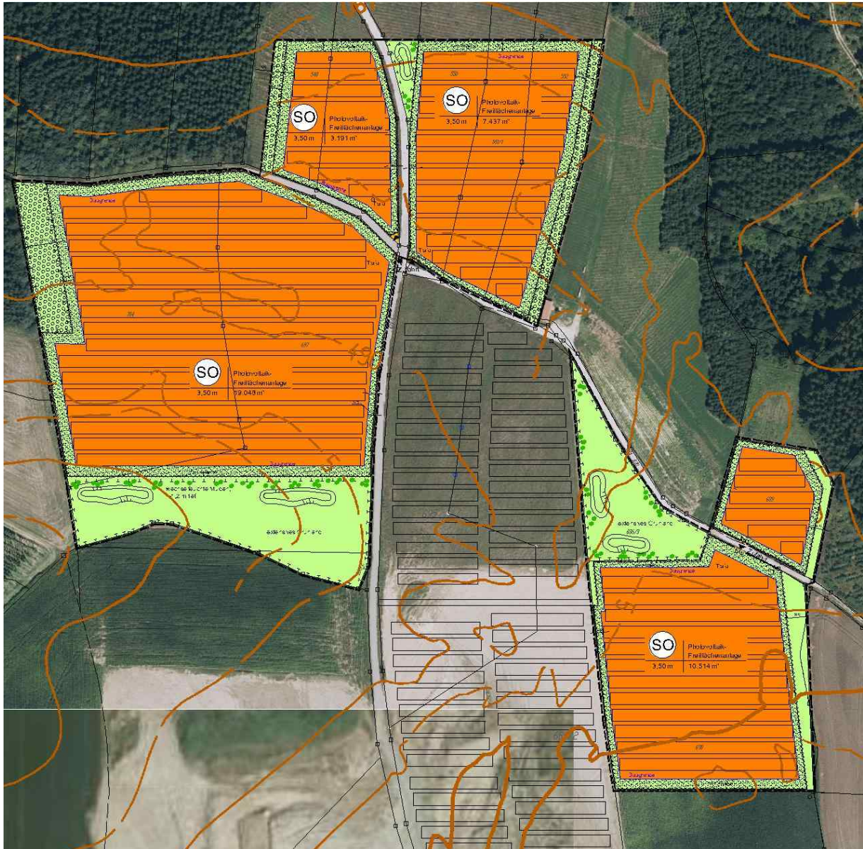
Bebauungsplan für die Photovoltaik-Freiflächenanlage Mittersberg Erweiterung. Im südlichen Bereich ist die bestehende Anlage zu sehen.
