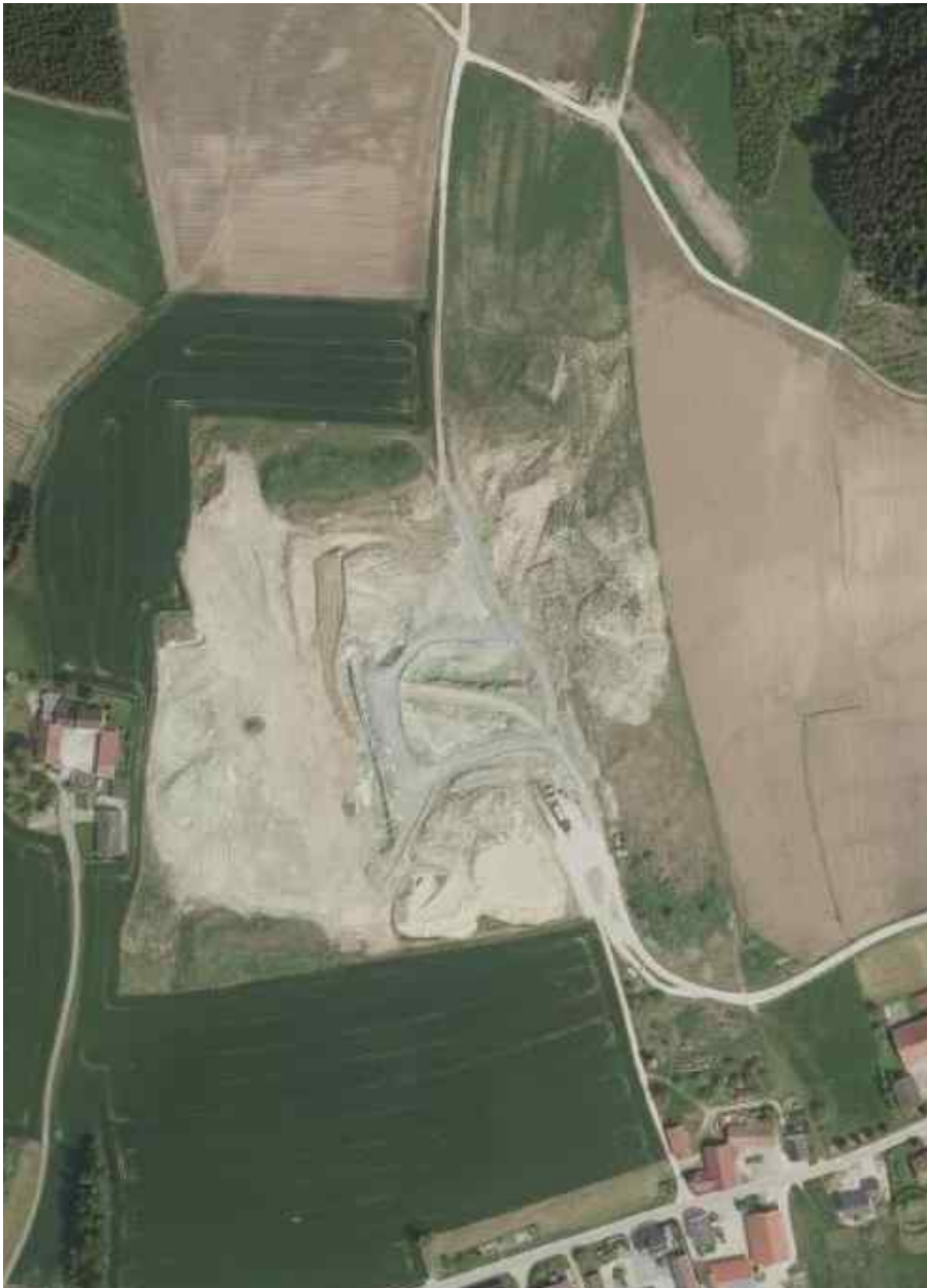
Die für die Photovoltaik-Freiflächenanlage beantragte Fläche wurde als Tontagebau der Firma Clariant zum Abbau von Bentonit genutzt. Der nördliche Teil wurde bereits wiederverfüllt und angedeckt.
